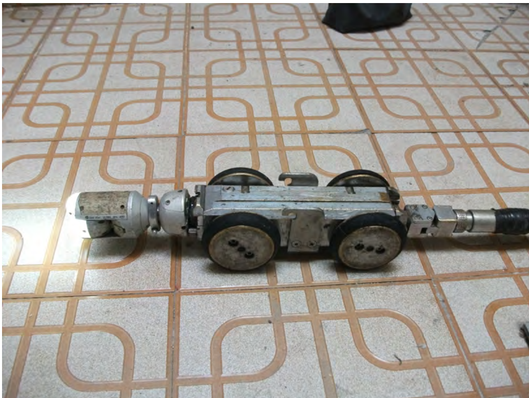
Fig. 11: Dispositivo robótico dispuesto para introducirse en una conducción.
