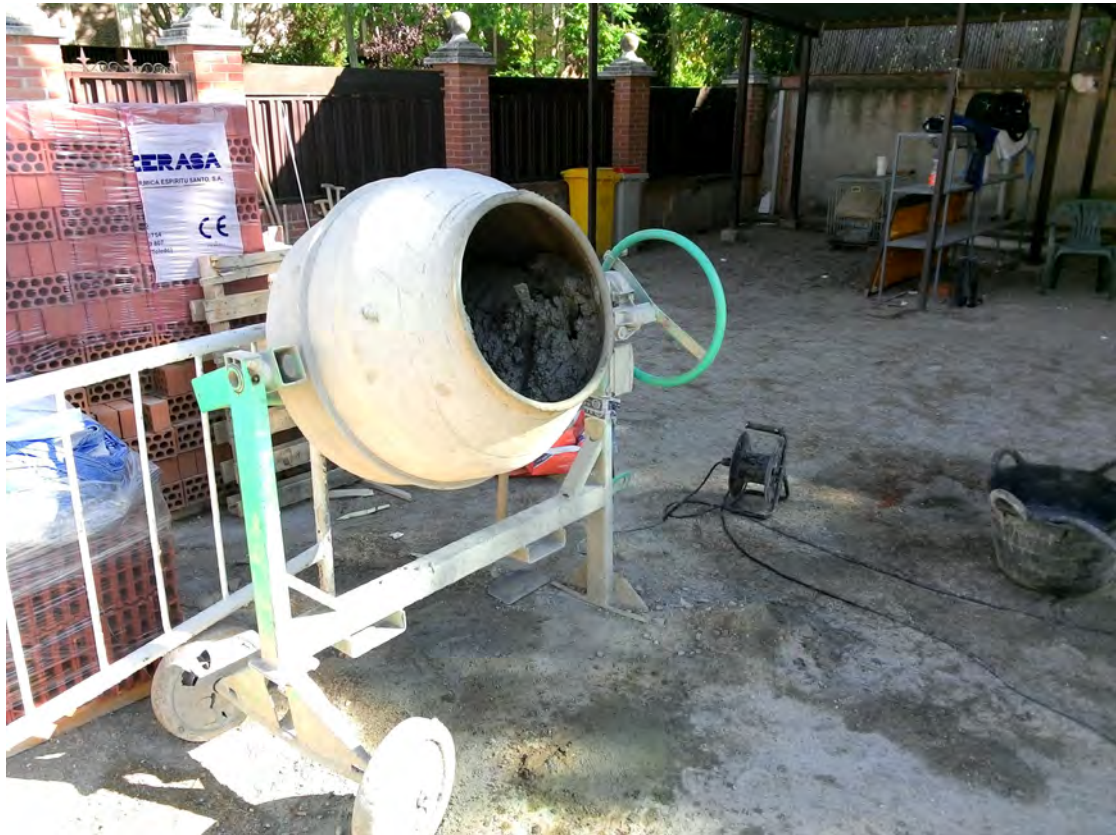
Fig. 34: Hormigonera eléctrica, empleada para fabricar “la pasta” que servirá de aglomerante.
